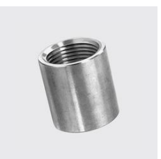
R-201 Muffe Unique-Id: R201 2 1/2, Gewinde ZOLL: 2 1/2, Materialart: Edelstahl rostbeständig, Länge mm: 65, Werkstoff: 1.4404, SKU 17136240
