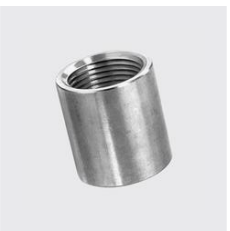
R-201 Muffe Länge mm: 43, Unique-Id: R201 1, Materialart: Edelstahl rostbeständig, Gewinde ZOLL: 1, Werkstoff: 1.4404, SKU 17136200
