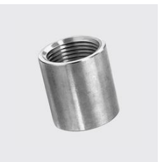
R-201 Muffe Länge mm: 26, Gewinde ZOLL: 3/8, Materialart: Edelstahl rostbeständig, Unique-Id: R201 3/8, Werkstoff: 1.4404, SKU 17136170
