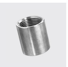
R-201 Muffe Unique-Id: R201 1 1/2, Materialart: Edelstahl rostbeständig, Länge mm: 48, Gewinde ZOLL: 1 1/2, Werkstoff: 1.4404, SKU 17136220
