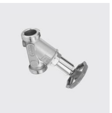
P-770-G Schrägsitzventil PN16, ohne Entleerung, beidseitig AG Länge mm: 70, Ausßen-Ø mm: 15, Gewinde ZOLL: 3/4, Materialart: Edelstahl rostbeständig, Unique-Id: P770-G- 15x3/4, Werkstoff: 316, SKU 14210150
