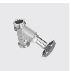
P-770-G Schrägsitzventil PN16, ohne Entleerung, beidseitig AG Länge mm: 97, Ausßen-Ø mm: 28, Materialart: Edel- stahl rostbeständig, Werkstoff: 316, Gewinde ZOLL: 1 1/4, Unique-Id: P770-G-28x 1 1/4, SKU 14210280
