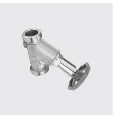
P-770-G Schrägsitzventil PN16, ohne Entleerung, beidseitig AG Ausßen-Ø mm: 42, Unique-Id: P770-G-42x 1 3/4, Gewinde ZOLL: 1 3/4, Länge mm: 130, Materialart: Edelstahl rost- beständig, Werkstoff: 316, SKU 14210420
