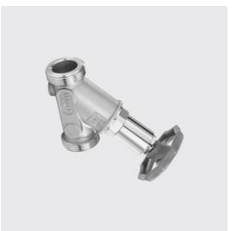
P-770-G Schrägsitzventil PN16, ohne Entleerung, beidseitig AG Ausßen-Ø mm: 54, Gewinde ZOLL: 2 3/8, Länge mm: 145, Unique-Id: P770-G-54x2 3/8, Materialart: Edelstahl rostbeständig, Werkstoff: 316, SKU 14210540
