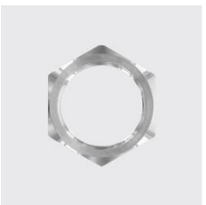
DIN 431 B Sechskant-Rohrmutter 0,5 d mit Gas- (Rohr-) Gewinde DIN 431 B Materialart: Edelstahl rostbeständig, Gewinde ZOLL: 3/4, Werkstoff: 1.4301, Unique-Id: D431R-3/4, SKU 5210204
