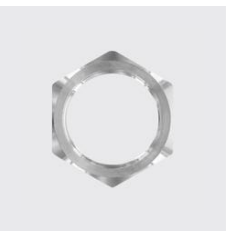
DIN 431 B Sechskant-Rohrmutter 0,5 d mit Gas- (Rohr-) Gewinde DIN 431 B Materialart: Edelstahl rostbeständig, Werkstoff: 1.4301, Gewinde ZOLL: 3/8, Unique-Id: D431R-3/8, SKU 5210202
