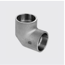
I-222 Coude à emboîter Type de matériau: acier inoxydable, ID unique: I222 60.3 Matériau: 1.4404, Ø extérieur mm : 60.3, SKU 17177282
