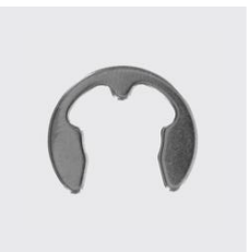
DIN 6799 Sicherungsscheibe für Wellen Typ RS DIN 6799 Materialart: Edelstahl rostbeständig, Werkstoff: A2, Nenn-Ø mm: 5, Unique-Id: D6799-5, SKU 5262505
