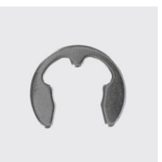
DIN 6799 Sicherungsscheibe für Wellen Typ RS DIN 6799 Materialart: Edelstahl rostbeständig, Unique-Id: D6799-10, Werkstoff: A2, Nenn-Ø mm: 1.0, SKU 5262510
