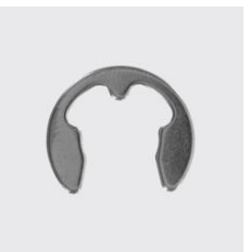
DIN 6799 Sicherungsscheibe für Wellen Typ RS DIN 6799 Materialart: Edelstahl rostbeständig, Werkstoff: A2, Unique-Id: D6799-1.5, Nenn-Ø mm: 1.5, SKU 52625015
