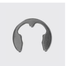
DIN 6799 Sicherungsscheibe für Wellen Typ RS DIN 6799 Materialart: Edelstahl rostbeständig, Unique-Id: D6799-4, Werkstoff: A2, Nenn-Ø mm: 4, SKU 5262504
