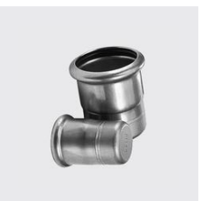
P-723 Cape de fermeture, inoxPRES® Matériau: 1.4404, ID unique: P723.54, Ø extérieur mm: 54, Type de matériau: acier inoxydable, Longueur totale mm: 62, SKU 14123540
