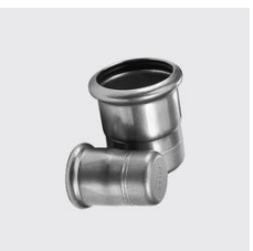
P-723 Cape de fermeture, inoxPRES® Ø extérieur mm: 42, ID unique: P723.42, Matériau: 1.4404, Longueur totale mm: 56, Type de matériau: acier inoxydable, SKU 14123420
