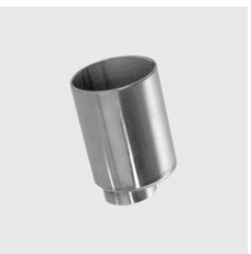
P-7215 Bouchon d'opturation avec filetage femelle excentré, inoxPRES® Ø extérieur mm: 54, Type de matériau: acier inoxydable, ID unique: P7215.54x1/2.E, Filetage POUCE: 1/2, Matériau: 1.4404, Longueur totale mm: 74,5, SKU 141231480
