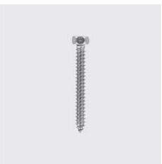
DIN 7976 C Sechskant-Blechschraube mit Spitze Form C DIN 7976 C Länge mm: 16, Ausssen-Ø mm: 3,9, Materialart: Edelstahl rostbeständig, Unique-Id: D7976C-3-9x16, Werkstoff: A2, SKU 5167239016
