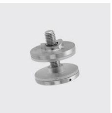
GG-4124 Fixation ponctuelle plate, Ø 50 mm, meulée Ø extérieur mm: 50, Type de matériau: acier inoxydable, ID unique: GG4124 42.4, Filetage: M12, pour tube mm: 42.4, Matériau: 316, SKU 188739720
