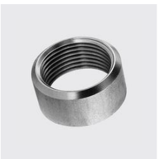
R-203 Demi-manchon Matériau: 1.4307, Type de matériau: acier inoxydable, ID unique: R203 4307 1, Filetage POUCE : 1, Longueur mm: 19.5, SKU 17138060
