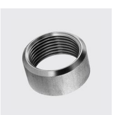
R-203 Demi-manchon Longueur mm: 11, Filetage POUCE : 1/4, Type de matériau: acier inoxydable, Matériau: 1.4404, ID unique: R203 4404 1/4, SKU 17138160
