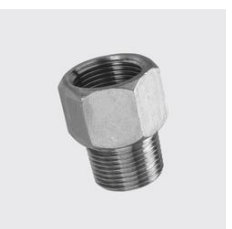
R-420 Verlängerung Zoll/Zoll Gewinde ZOLL: 1/4, Länge Total mm: 29.9, Materialart: Edelstahl rostbeständig, Werkstoff: 1.4408, Unique-Id: R420 1/4, SKU 172481220
