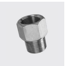
R-420 Verlängerung Zoll/Zoll Länge Total mm: 32.3, Materialart: Edelstahl rostbeständig, Werkstoff: 1.4408, Unique-Id: R420 3/8, Gewinde ZOLL: 3/8, SKU 172481260
