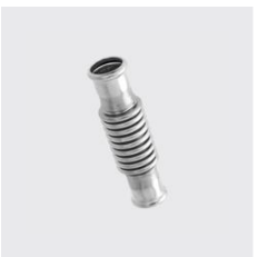
P-741 Compensateur d'expansion PN10, inox-PRES® Type de matériau: acier inoxydable, Matériau: 1.4404, Ø extérieur mm: 15, Longueur mm: 139, ID unique: P741 15, SKU 14150150
