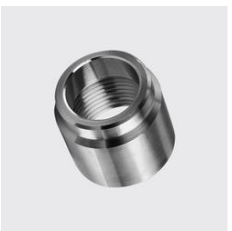
R-404 Anschweissmuffe, Innengewinde Länge Total mm: 31, Werkstoff: 1.4404, Materialart: Edelstahl rostbeständig, Gewinde ZOLL: 1, Unique-Id: R404 1x42.4, Ausßen-Ø mm: 42.4, SKU 171396570
