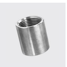
R-201 Muffe Unique-Id: R201 5, Materialart: Edelstahl rostbeständig, Werkstoff: 1.4404, Gewinde ZOLL: 5, Länge mm: 92, SKU 17136270
