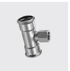
P-763 T-Stück, mit Abgang Innengewinde, inox-PRES® Werkstoff: 1.4404, Unique-Id: P763 76x1, Aussen-Ø mm: 76,1, Materialart: Edelstahl rostbeständig, Gewinde ZOLL: 1, SKU 14163762
