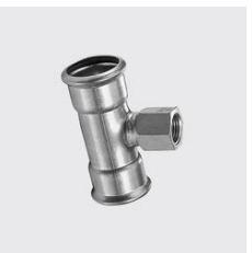
P-763 T-Stück, mit Abgang Innengewinde, inox-PRES® Werkstoff: 1.4404, Materialart: Edelstahl rostbeständig, Aussen-Ø mm: 88,9, Gewinde ZOLL: 3/4, Unique-Id: P763 88x3/4, SKU 14163881
