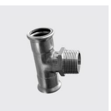
P-765 T-Stück, mit Aussengewinde, konisch, inox-PRES® Materialart: Edelstahl rostbeständig, Aussen-Ø mm: 18, Unique-Id: P765 18x1/2 E, Werkstoff: 1.4404, Gewinde ZOLL: 1/2, SKU 141652220
