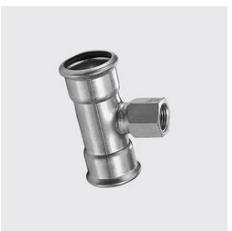
P-763 T-Stück, mit Abgang Innengewinde, inox-PRES® Werkstoff: 1.4404, Aussen-Ø mm: 108, Materialart: Edelstahl rostbeständig, Gewinde ZOLL: 3/4, Unique-Id: P763 108x3/4, SKU 14163901
