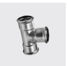
P-760 T-Stück, egal, inoxPRES® Aussen-Ø mm: 35, Materialart: Edelstahl rostbeständig, Unique-Id: P760 35, Werkstoff: 1.4404, SKU 14160350
