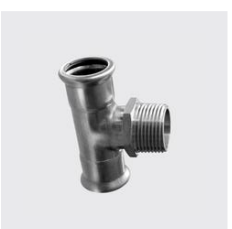
P-765 T-Stück, mit Aussengewinde, konisch, inox-PRES® Materialart: Edelstahl rostbeständig, Gewinde ZOLL: 3/4, Aussen-Ø mm: 22, Werkstoff: 1.4404, Unique-Id: P765 22x3/4 E, SKU 141652240
