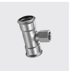
P-763 T-Stück, mit Abgang Innengewinde, inox-PRES® Werkstoff: 1.4404, Materialart: Edelstahl rostbeständig, Aussen-Ø mm: 88,9, Gewinde ZOLL: 2, Unique-Id: P763 88x2, SKU 14163885
