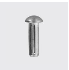
DIN 1476 Clou cannelé à tête demi-ronde DIN 1476 ID unique: D1476-2x8, Matériau: A2, Longueur mm: 8, Ø mm: 2, Type de matériau: acier inoxydable, SKU 5310202008
