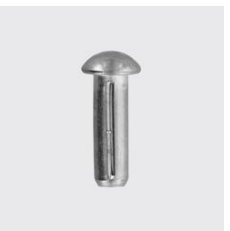
DIN 1476 Clou cannelé à tête demi-ronde DIN 1476 ID unique: D1476-2x4, Matériau: A2, Ø mm: 2, Type de matériau: acier inoxydable, Longueur mm: 4, SKU 5310202004
