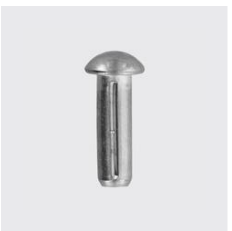
DIN 1476 Clou cannelé à tête demi-ronde DIN 1476 Matériau: A2, Longueur mm: 10, Ø mm: 2, Type de matériau: acier inoxydable, ID unique: D1476-2x10, SKU 5310202010
