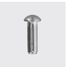
DIN 1476 Clou cannelé à tête demi-ronde DIN 1476 Matériau: A2, ID unique: D1476-2x6, Ø mm: 2, Type de matériau: acier inoxydable, Longueur mm: 6, SKU 5310202006
