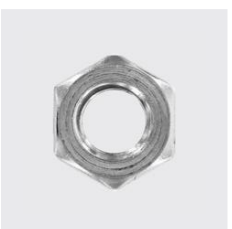
DIN 934 Sechskantmutter 0,8 d DIN 934 Materialart: Edelstahl rostbeständig, Gewinde: M30, Werkstoff: A4, Unique-Id: D934+30, SKU 5211430
