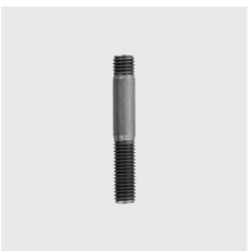
DIN 939 Stiftschraube Einschraubende 1,25 d DIN 939 Unique-Id: D939-12x55, Materialart: Edelstahl rostbeständig, Werkstoff: A2, Gewinde: M12, Länge mm: 55, SKU 5234212055
