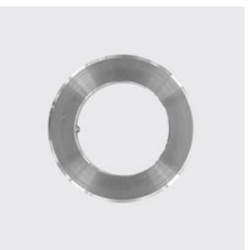
DIN 705 A Bague d'arrêt, série légère avec vis sans tête DIN 705 A Ø mm: 36, Matériau: 1.4305, Type de matériau: acier inoxydable, ID unique: D705A-36, SKU 5314236
