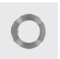
DIN 705 A Bague d'arrêt, série légère avec vis sans tête DIN 705 A Ø mm: 50, Matériau: 1.4305, ID unique: D705A-50, Type de matériau: acier inoxydable, SKU 5314250
