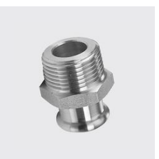
P-733 Übergang mit Aussengewinde, inoxPRES® Gewinde ZOLL: 1/2, Länge Total mm: 46, Aussen-Ø mm: 28, Unique-Id: P733 28x1/2, Werkstoff: 1.4404, Materialart: Edelstahl rostbeständig, SKU 141333280
