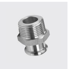
P-733 Übergang mit Aussengewinde, inoxPRES® Gewinde ZOLL: 1/2, Aussen-Ø mm: 18, Werkstoff: 1.4404, Unique-Id: P733 18x1/2, Länge Total mm: 41, Materialart: Edelstahl rostbeständig, SKU 141333180
