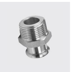
P-733 Übergang mit Aussengewinde, inoxPRES® Aussen-Ø mm: 18, Gewinde ZOLL: 3/4, Länge Total mm: 44, Werkstoff: 1.4404, Unique-Id: P733 18x3/4, Materialart: Edelstahl rostbeständig, SKU 141333181
