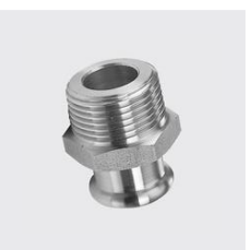
P-733 Übergang mit Aussengewinde, inoxPRES® Gewinde ZOLL: 3/4, Aussen-Ø mm: 28, Werkstoff: 1.4404, Länge Total mm: 47, Unique-Id: P733 28x3/4, Materialart: Edelstahl rostbeständig, SKU 141333281
