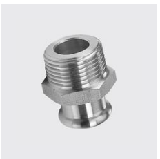
P-733 Übergang mit Aussengewinde, inoxPRES® Gewinde ZOLL: 3/4, Länge Total mm: 44, Werkstoff: 1.4404, Unique-Id: P733 22x3/4, Aussen-Ø mm: 22, Materialart: Edelstahl rostbeständig, SKU 141333220
