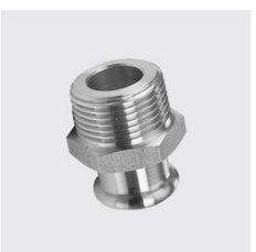
P-733 Übergang mit Aussengewinde, inoxPRES® Gewinde ZOLL: 1/4, Aussen-Ø mm: 35, Werkstoff: 1.4404, Länge Total mm: 55, Materialart: Edelstahl rostbeständig, Unique-Id: P733 35x1 1/4, SKU 141333353
