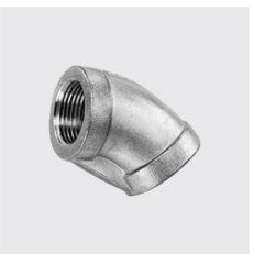
R-303 Winkel 45° , innen / innen Gewinde ZOLL: 3/4, Unique-Id: R303 3/4, Materi- alart: Edelstahl rostbeständig, Werkstoff: 1.4408, SKU 17189140
