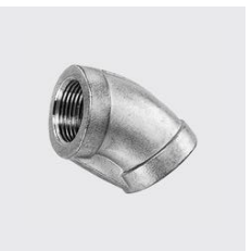
R-303 Winkel 45° , innen / innen Gewinde ZOLL: 1/8, Materialart: Edelstahl rostbeständig, Unique-Id: R303 1/8, Werkstoff: 1.4408, SKU 17189095
