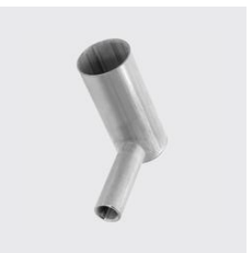
P-7110 Luftflasche mit Einsteckende und 1/2" Muffe, inoxPRESS® Aussen-Ø mm: 28, Materialart: Edelstahl rostbeständig, Werkstoff: 1.4301, Unique-Id: P7110 28 E, SKU 141551120
