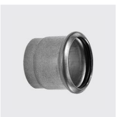
P-799 Anschweissmuffe ohne O-Ring, inoxPRESS® Länge mm: 29, Materialart: Edelstahl rostbeständig, Werkstoff: 1.4404, Aussen-Ø mm: 15, Unique-Id: P799 15, SKU 14409150
