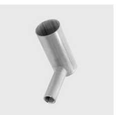
P-7110 Luftflasche mit Einsteckende und 1/2" Muffe, inoxPRESS® Materialart: Edelstahl rostbeständig, Werkstoff: 1.4301, Aussen-Ø mm: 88,9, Unique-Id: P7110 88,9 E, SKU 141551220
