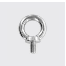
K-265 Ringschraube, gegossen, Form nach DIN 580 Werkstoff: A4, Gewinde: M10, Materialart: Edelstahl rostbeständig, Unique-Id: K265+10, SKU 5247410
