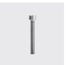
DIN 912 Zylinderschraube mit Innensechskant, ohne Schaft DIN 912 Gewinde: M6, Materialart: Edelstahl rostbeständig, Länge mm: 10, Werkstoff: A4, Unique-Id: D912+6x10, SKU 5140406010
