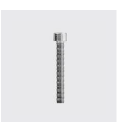
DIN 912 Vis à tête cylindrique à six pans creux, entièrement filetée DIN 912 ID unique: D912-12x35, Filetage: M12, Type de matériau: acier inoxydable, Longueur mm: 35, Matériau: A2, SKU 5140212035
