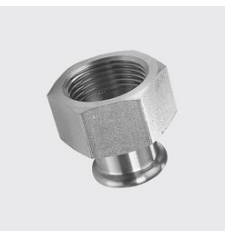
PG-734 Pièce intermédiaire avec filetage femelle, inoxPRES® GAS Matériau: 1.4404, Type de matériau: acier inoxydable, ID unique: PG734 35x1 1/2, Longueur totale mm: 52, Filetage POUCE : 1 1/2, Ø extérieur mm: 35, SKU 147441600
