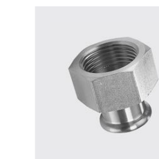
PG-734 Pièce intermédiaire avec filetage femelle, inoxPRES® GAS Matériau: 1.4404, Type de matériau: acier inoxydable, ID unique: PG734 42x1 1/2, Longueur totale mm: 56, Ø extérieur mm: 42, Filetage POUCE : 1 1/2, SKU 147441680
