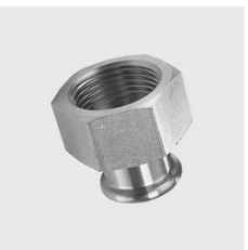
PG-734 Pièce intermédiaire avec filetage femelle, inoxPRES® GAS Matériau: 1.4404, Type de matériau: acier inoxydable, Ø extérieur mm: 54, Filetage POUCE : 1 1/2, ID unique: PG734 54x1 1/2, Longueur totale mm: 60, SKU 147441720
