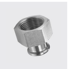
PG-734 Pièce intermédiaire avec filetage femelle, inoxPRES® GAS Matériau: 1.4404, ID unique: PG734 42x1 1/4, Type de matériau: acier inoxydable, Longueur totale mm: 56, Ø extérieur mm: 42, Filetage POUCE : 1 1/4, SKU 147441640
