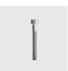
DIN 912 Vis à tête cylindrique à six pans creux, par-tiellement filetée DIN 912 Matériau: A2, Filetage: M24, Type de matériau: acier inoxydable, Longueur mm: 130, ID unique: D912-24x130, SKU 5140224130
