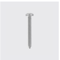
DIN 7981 C-T Linsen- Blechschraube mit Innensechsrund und Spitze, Form C ISO 14585 C-T- (Vormals DIN 7981 C-T) Werkstoff: A2, Ausssen-Ø mm: 4,8, Materialart: Edelstahl rostbeständig, Länge mm: 50, Unique-Id: D7981T-4-8x50, SKU 5169248500
