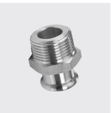
PG-733 Pièce intermédiaire avec filetage mâle conique, InoxPRES@ GAS Ø extérieur mm: 54, Filetage POUCE : 2, ID unique: PG733 54x2, Type de matériau: acier inoxydable, Matériau: 1.4404, Longueur totale mm: 71, SKU 147421800
