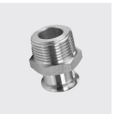
PG-733 Pièce intermédiaire avec filetage mâle conique, InoxPRES@ GAS Ø extérieur mm: 42, Filetage POUCE : 1 1/2, ID unique: PG733 42x1 1/2, Type de matériau: acier inoxydable, Longueur totale mm: 59, Matériau: 1.4404, SKU 147421720
