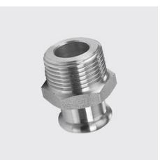
PG-733 Pièce intermédiaire avec filetage mâle conique, InoxPRES@ GAS Filetage POUCE : 3/4, Longueur totale mm: 44, Ø extérieur mm: 18, Type de matériau: acier inoxydable, Matériau: 1.4404, ID unique: PG733 18x3/4, SKU 147421280
