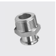
PG-733 Pièce intermédiaire avec filetage mâle conique, InoxPRES@ GAS Ø extérieur mm: 54, ID unique: PG733 54x1 1/2, Filetage POUCE : 1 1/2, Type de matériau: acier inoxydable, Matériau: 1.4404, Longueur totale mm: 65, SKU 147421760
