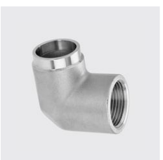
R-222-S Winkel 90°, Innengewinde/Anschweis- sende Werkstoff: 316L, Materialart: Edelstahl rostbeständig, Gewinde ZOLL: 1/2, Ausßen-Ø mm: 21,3, Unique-Id: R222-S 1/2, SKU 172561500
