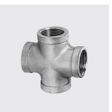
R-302 Kreuz-Stück, egal, Innengewinde Werkstoff: 1.4408, Unique-Id: R302 1/8, Gewinde ZOLL.: 1/8, Länge Total mm: 38, Materialart: Edelstahl rostbeständig, SKU 17187080
