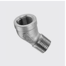
R-306 Winkel 45° , Innen-/Aussengewinde Materialart: Edelstahl rostbeständig, Werkstoff: 1.4408, Gewinde ZOLL: 1/4, Unique-Id: R306 1/4, SKU 171932110
