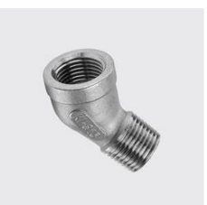
R-306 Winkel 45° , Innen-/Aussengewinde Unique-Id: R306 1 1/4, Materialart: Edelstahl rost- beständig, Werkstoff: 1.4408, Gewinde ZOLL: 1 1/4, SKU 171932160
