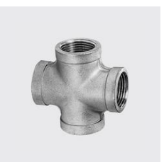
R-302 Kreuz-Stück, egal, Innengewinde Werkstoff: 1.4408, Gewinde ZOLL.: 3/8, Unique-Id: R302 3/8, Länge Total mm: 46, Materialart: Edelstahl rostbeständig, SKU 17187110
