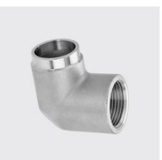
R-222-S Winkel 90°, Innengewinde/Anschweis- sende Werkstoff: 316L, Unique-Id: R222-S 3/8, Materialart: Edelstahl rostbeständig, Gewinde ZOLL: 3/8, Ausßen-Ø mm: 17,2, SKU 172561490
