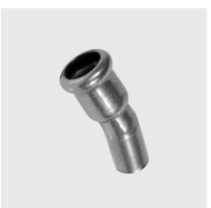
P-707 Bogen 15° , innen - aussen, inoxPRES® Aussen-Ø mm: 22, Unique-Id: P707 22, Materi- alart: Edelstahl rostbeständig, Werkstoff: 1.4404, SKU 141141110
