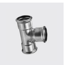
PG-760 Té égal, inoxPRES® GAS Ø extérieur mm: 22, ID unique: PG760 22, Type de matériau: acier inoxydable, Matériau: 1.4404, SKU 147521200
