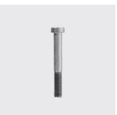
DIN 6912 Vis à tête cylindrique à six pans creux, à tête basse et trou de guidage DIN 6912 Matériau: A2, Filetage: M6, Type de matériau: acier inoxydable, Longueur mm: 50, ID unique: D6912-6x50, SKU 5146206050
