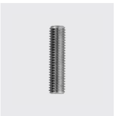
DIN 913 Gewindestift mit Innensechskant und Kegekuppe ISO 4026 vormals (DIN 913) Länge mm: 8, Unique-Id: D913+4x8, Gewinde: M4, Werkstoff: A4, Materialart: Edelstahl rostbeständig, SKU 5141404008
