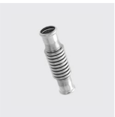
P-741 Wellenkompensator PN10, inoxPRESS® Materialart: Edelstahl rostbeständig, Werkstoff: 1.4404, Unique-Id: P741 22, Länge mm: 139, Aussen-Ø mm: 22, SKU 14150220
