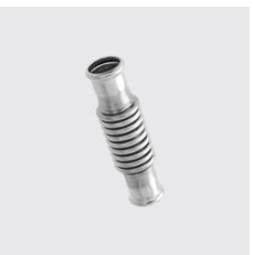
P-741 Wellenkompensator PN10, inoxPRESS® Materialart: Edelstahl rostbeständig, Werkstoff: 1.4404, Aussen-Ø mm: 35, Länge mm: 177, Unique-Id: P741 35, SKU 14150350
