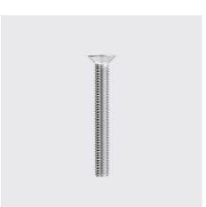
DIN 965 A Senkschraube mit Kreuzschlitz Phillips Form H DIN 965 A Materialart: Edelstahl rostbeständig, Unique-Id: D965-8x100, Länge mm: 100, Werkstoff: A2, Gewinde: M8, SKU 5131208100
