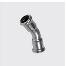
P-708 Bogen 30° , innen - innen, inoxPRES® Aussen-Ø mm: 22, Unique-Id: P708 22, Werkstoff: 1.4404, Materialart: Edelstahl rostbeständig, SKU 141141210
