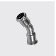
P-708 Bogen 30° , innen - innen, inoxPRES® Unique-Id: P708 18, Werkstoff: 1.4404, Materialart: Edelstahl rostbeständig, Aussen-Ø mm: 18, SKU 141141205
