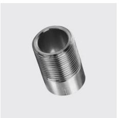
R-208-Z Anschweissnippel, Gewinde zylindrisch Gewinde ZOLL: 3/4, Materialart: Edelstahl rostbeständig, Länge Total mm: 30, Unique-Id: R208-Z 3/4, Werkstoff: 1.4404, SKU 17143535
