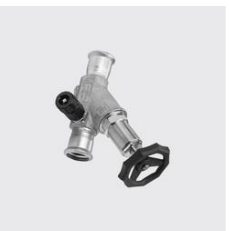
P-776 Schrägsitzventil mit Rückflussverhinderer, mit Entleerung, PN16, Ausßen-Ø mm: 22, Länge Total mm: 125, Unique-Id: P776 22, Materialart: Edelstahl rostbeständig, Werkstoff: 316, SKU 14203220
