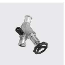
P-776 Schrägsitzventil mit Rückflussverhinderer, mit Entleerung, PN16, Unique-Id: P776 54, Materialart: Edelstahl rostbeständig, Ausßen-Ø mm: 54, Länge Total mm: 222, Werkstoff: 316, SKU 14203540
