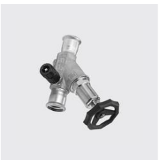
P-776 Schrägsitzventil mit Rückflussverhinderer, mit Entleerung, PN16, Ausßen-Ø mm: 28, Unique-Id: P776 28, Materialart: Edelstahl rostbeständig, Werkstoff: 316, Länge Total mm: 146, SKU 14203280
