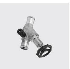
P-776 Schrägsitzventil mit Rückflussverhinderer, mit Entleerung, PN16, Unique-Id: P776 42, Länge Total mm: 189, Ausßen-Ø mm: 42, Materialart: Edelstahl rostbeständig, Werkstoff: 316, SKU 14203420
