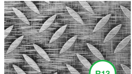
3 SE-TB1 (636) längs und quer überschleiffen léger meulage longitudinal et perpendiculaire additionnel
